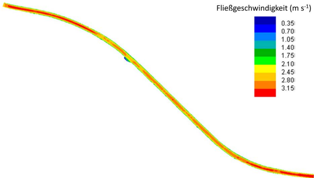
Abbildung 59. Fließgeschwindigkeiten des Durchflusses eines einjährigen Hochwassers in der aktuellen Morphologie des Referenzabschnitts.
