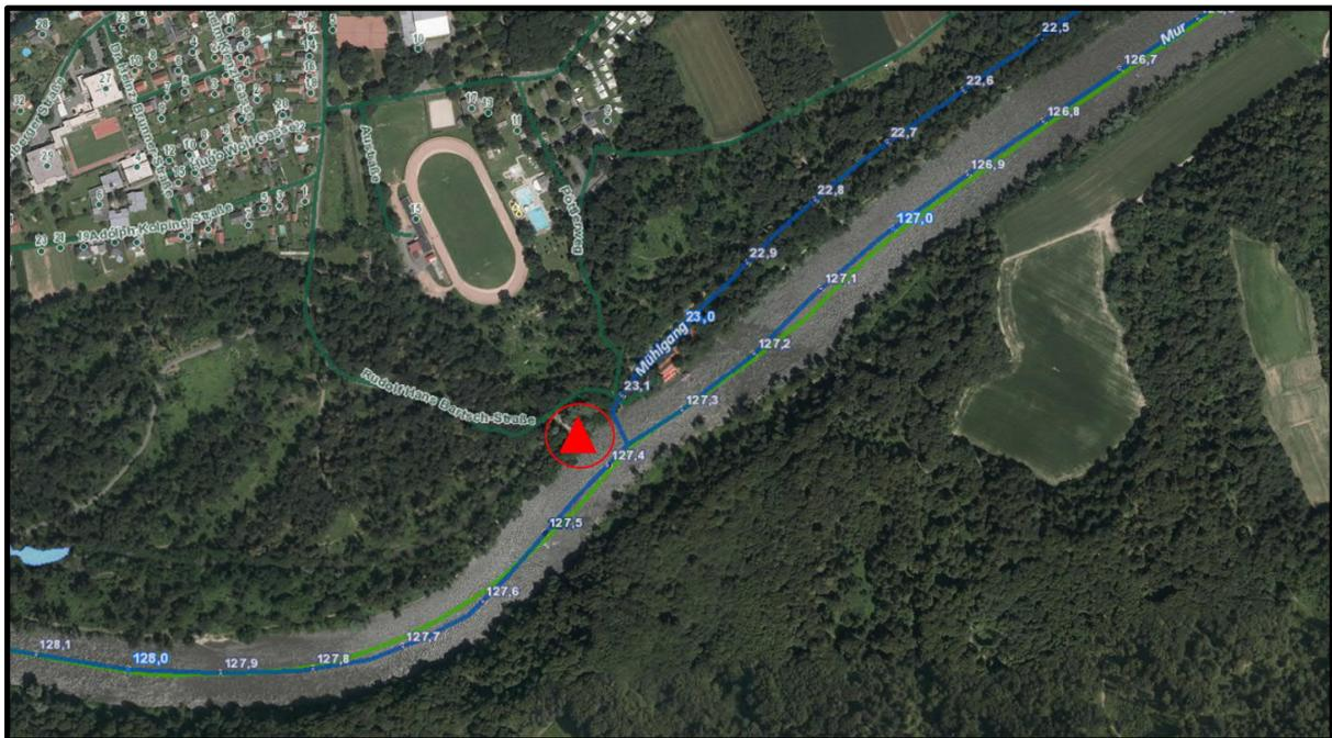
Abbildung 22: Situierung Variante 4 – Errichtung einer Pumpstation, ~ FL-km 127,4
