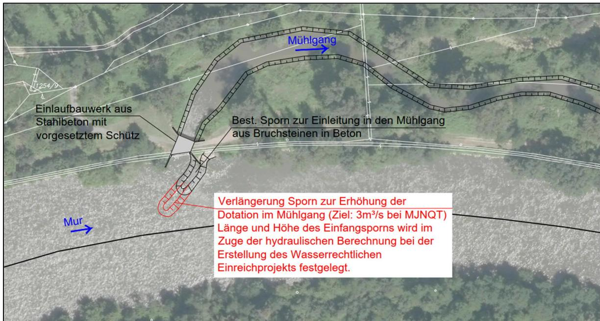
Abbildung 17: Schematische Darstellung Variante 1: Verlängerung Einfangsporn aus Bruchsteinen in Beton
