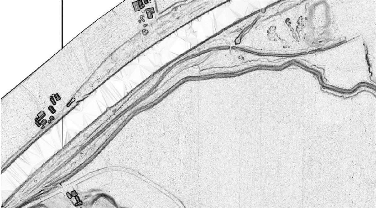
Bild 4: Überrest des einstigen Gerinnes des Vizjak-Kanals im Einlaufbereich bei Vratja vas (schattiertes Relief aufgrund von LIDAR-Daten, Quelle: gisserver.gov.si).
