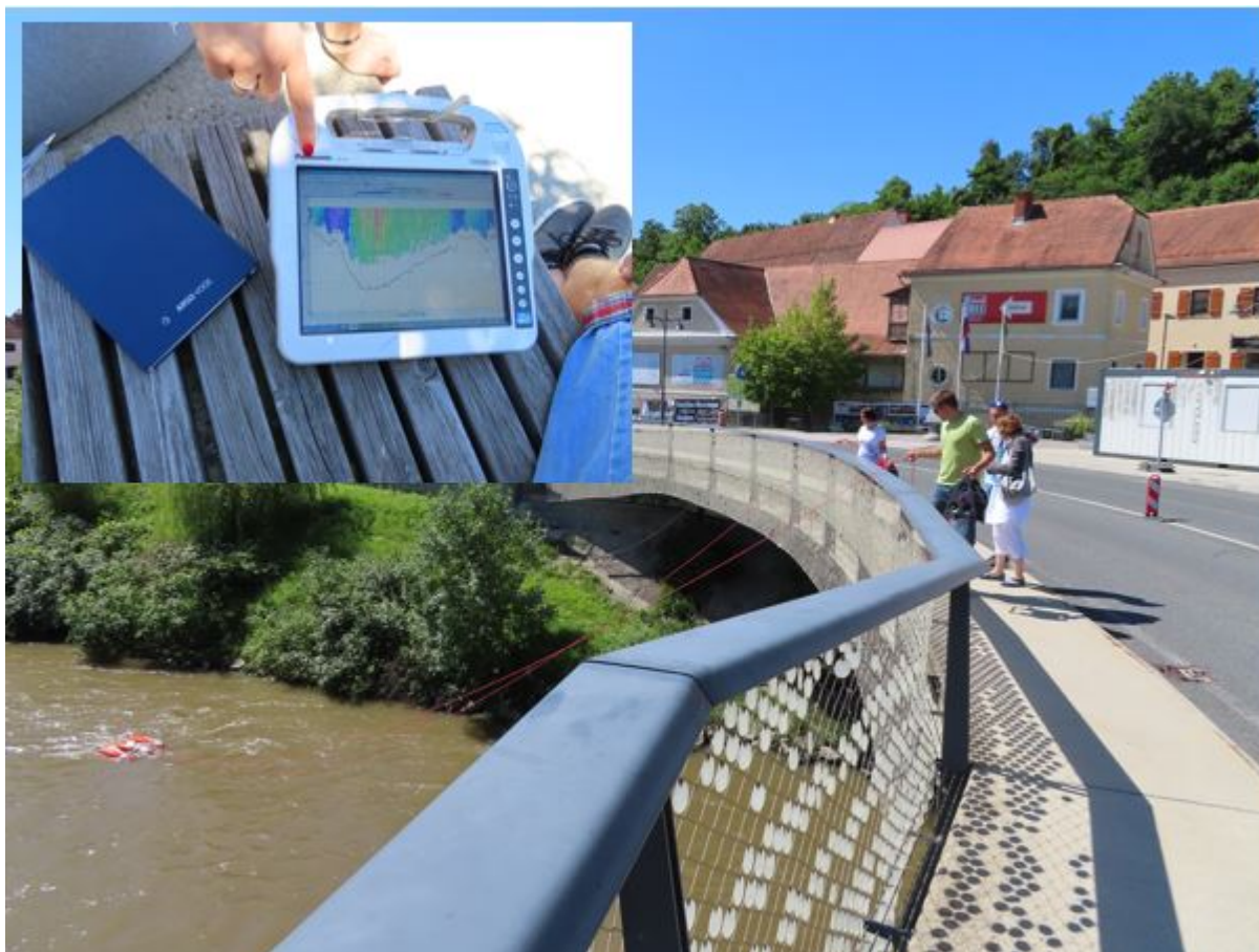
Slika I.4: Meritve pretoka Mure z mostu med Gornjo Radgono in avstrijsko Radgono (vir: Arhiv ARSO).
