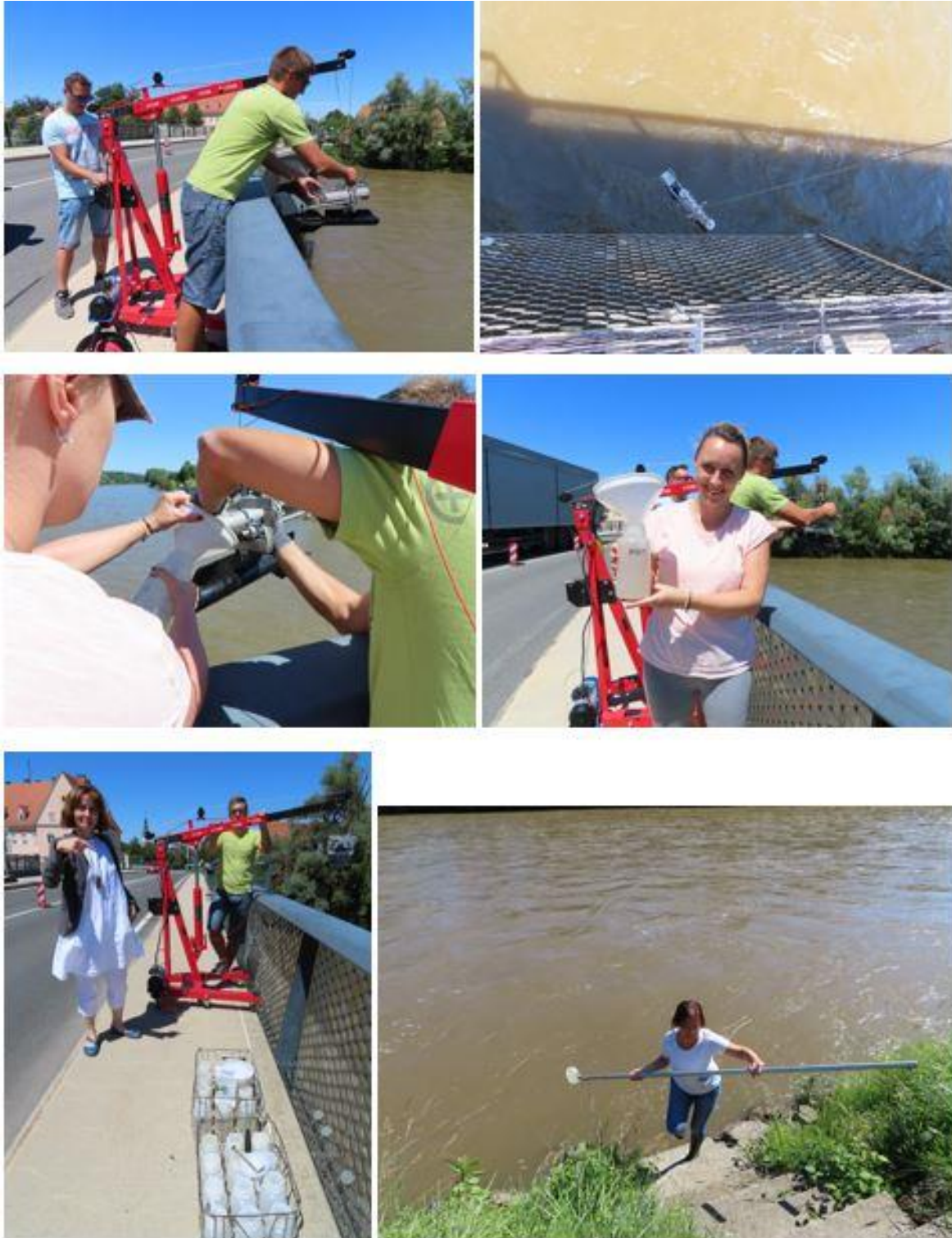
Abb. I.16: Durchführung der Profilmessung von suspendiertem Material (Quelle: Archiv ARSO).
